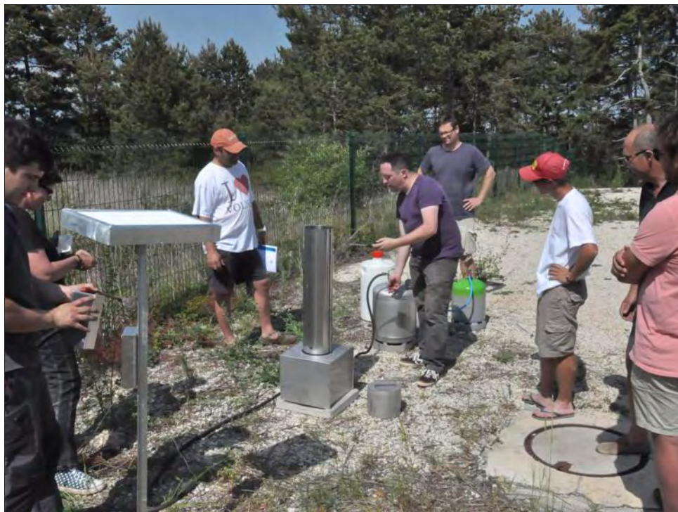
Le premier générateur à vortex anti-grêle a été posé à Volnay. Photo F. B.
