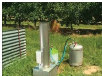
Poste générateur au sol d'iode d'argent. (photo ANELFA)
