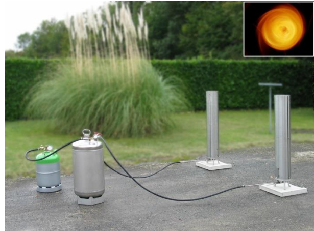
Fig. 1. Générateur à vortex à double cheminée utilisé en certains endroits de la côte atlantique française, avec une vue de dessus de la combustion dans une cheminée (les générateurs ordinaires ne possèdent qu'une cheminée).
