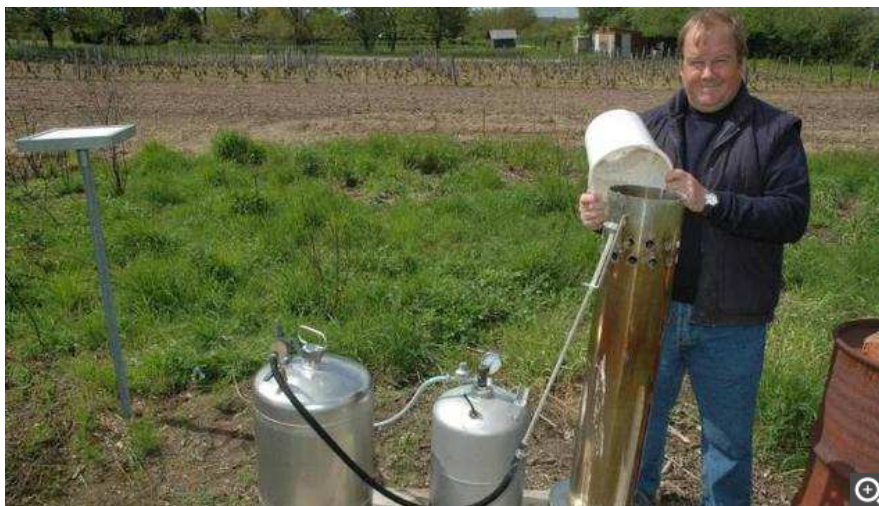
Les générateurs utilisés par le réseau diffusant de l'iodure d'argent en altitude pour réduire la taille des grêlons. - (Photo archives NR)
