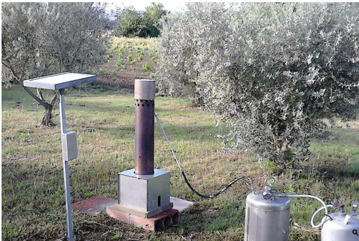
Dans le Sud-Drôme, 27 diffuseurs d'iodure d'argent sont installés pour lutter contre la grêle. Photo ANEFLA
