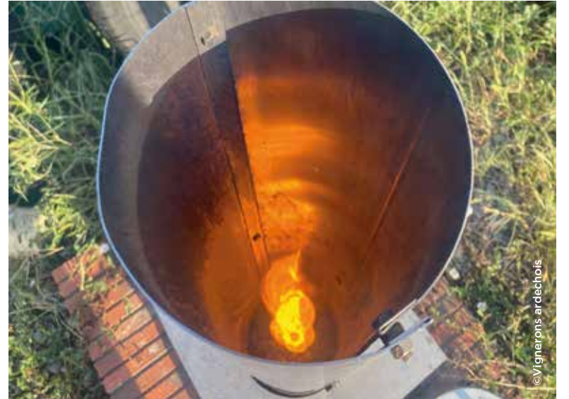
La flamme fournit la chaleur nécessaire pour permettre l'émission de l'iodure d'argent sous forme de très fines particules.
