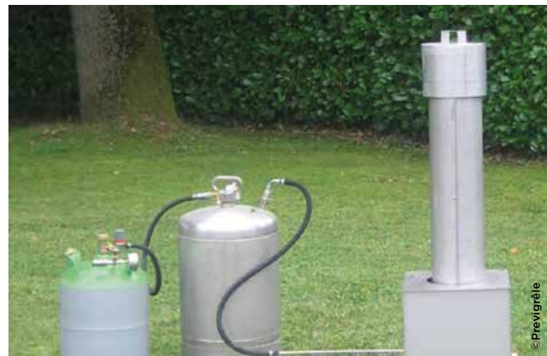
▲ Générateur terrestre à vortex.
