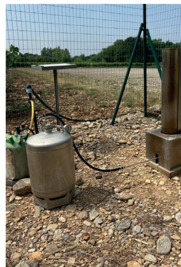
▲ Le générateur terrestre à vortex dispose d'un réservoir d'iodure d'argent de 25 l, à raison d'une diffusion de 1,1 l/h.
