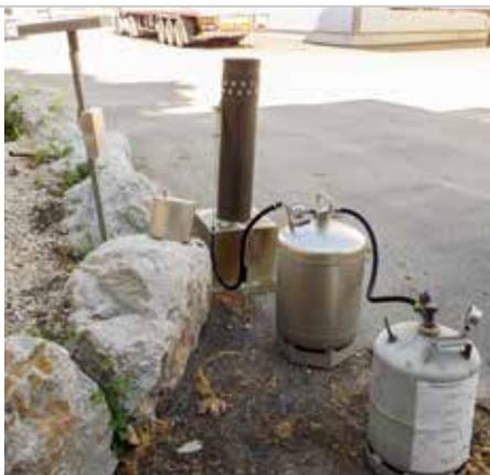
Le dispositif silencieux comprend une cheminée reliée à deux bonbonnes, l'une pour la solution d'iodure d'argent, l'autre pour l'air comprimé.
